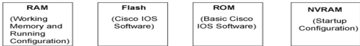
شکل ۷-۴ انواع حافظه مسیریاب سیسکو
