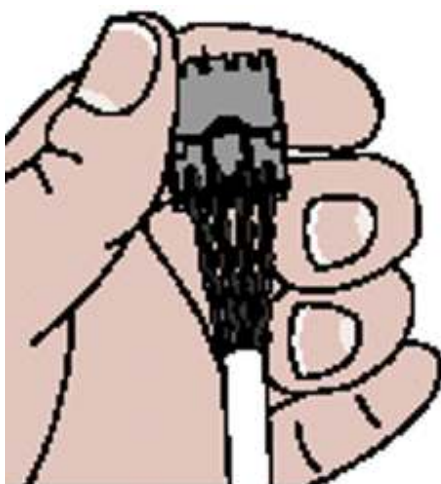
شکل 7۱۱- قرار دادن سر سیم‌ها به طور کامل در Connector
