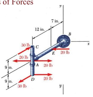
$$\Rightarrow \vec{M} = -(540 \text{ lb} \cdot \text{in.}) \vec{i} + (240 \text{ lb} \cdot \text{in.}) \vec{j} + (180 \text{ lb} \cdot \text{in.}) \vec{k}$$
