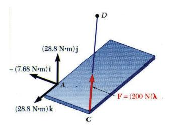
$$\Rightarrow \boxed{\vec{M}_A = -(7.68 \text{ N} \cdot \text{m})\vec{i} + (28.8 \text{ N} \cdot \text{m})\vec{j} + (28.8 \text{ N} \cdot \text{m})\vec{k}}$$
