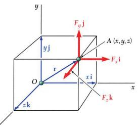
$$\vec{M}_{O} = M_{x}\vec{i} + M_{y}\vec{j} + M_{z}\vec{k} = \begin{vmatrix} \vec{i} & \vec{j} & \vec{k} \\ x & y & z \\ F_{x} & F_{y} & F_{z} \end{vmatrix} = (yF_{z} - zF_{y})\vec{i} + (zF_{x} - xF_{z})\vec{j} + (xF_{y} - yF_{x})\vec{k}$$
