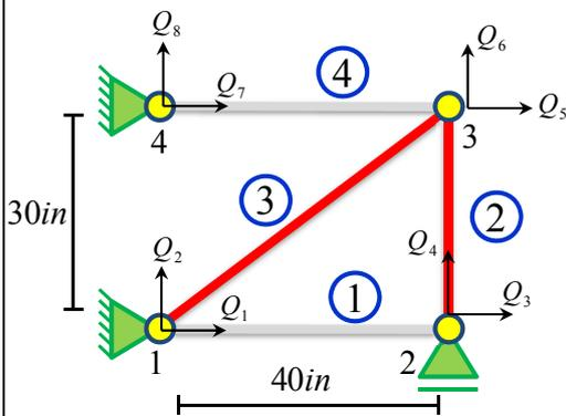
$$(L04-95) \Rightarrow \begin{cases} R_1 \\ R_2 \\ R_4 \\ R_7 \\ R_8 \end{cases} = \begin{bmatrix} K_{11} & K_{12} & \dots & K_{18} \\ K_{21} & K_{22} & \dots & K_{28} \\ K_{41} & K_{42} & \dots & K_{48} \\ K_{71} & K_{72} & \dots & K_{78} \\ K_{81} & K_{82} & \dots & K_{88} \end{bmatrix} \begin{Bmatrix} Q_1 \\ Q_2 \\ Q_3 \\ Q_4 \\ Q_5 \\ Q_6 \\ Q_7 \\ Q_8 \end{Bmatrix} - \begin{Bmatrix} F_1 \\ F_2 \\ F_4 \\ F_7 \\ F_8 \end{Bmatrix} \quad (2.22)$$
