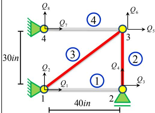
تشکیل ماتریس سختی کل خرپا به وسیله
